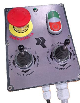
Figura 6.15 – Unidade de Comando Podadora
