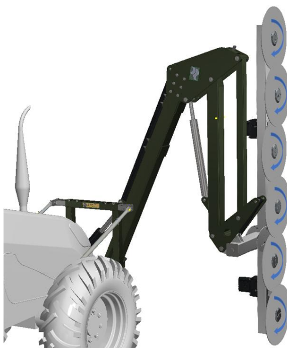
Figura 7.7 – Sentido de rotação dos discos de corte
